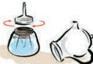
**3.** Avvitate saldamente la caldaia alla parte superiore del filtro in metallo e infilate sul birone centrale la parte superiore in porcellana dell'Espressina, facendola appoggiare sulla caldaia in acciaio.
